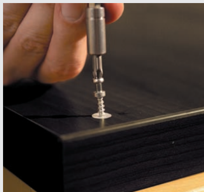
5. Установка стандартной фурнитуры после застывания клеевой массы
