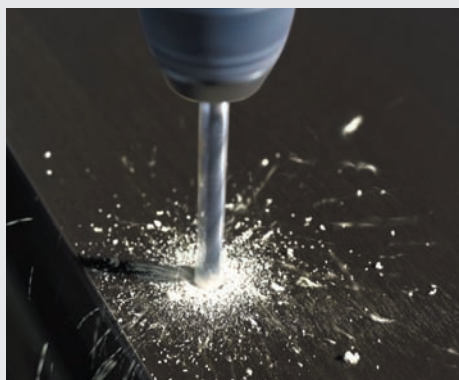
1. Сверление отверстия в легкой панели
